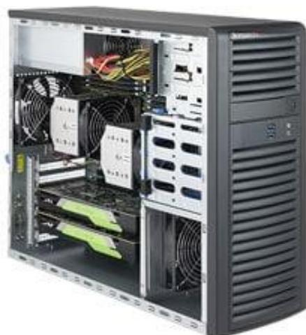
VT64 Workstation XS2-4S-CLXは、最新のインテル® Xeon® スケーラブル・プロセッサ「Cascade Lake」シリーズのGold 6238Rを2基搭載した4Uタワー型筐体にて構成される製品です。
